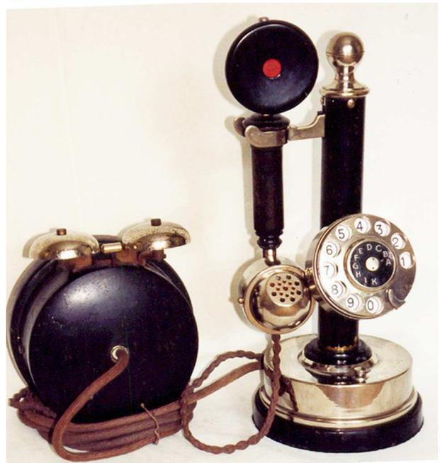
Zum kompletten Fernsprecher gehörte ein Beikasten, in dem die Induktionsspule, der Wecker und der Kondensator Platz fanden.
