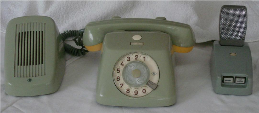
„E 2“ Tischapparat (Erdtaste oben) mit Transistor-Freisprecheinrichtung ab 1958
