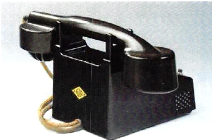
Apparateansicht von hinten; erkennbar vorne die Schallaustrittslöcher für den Wecker, die nur bei den Blechgehäusen vorhanden waren.
