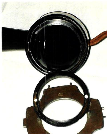
Die breiteren Stifte des Werkzeuges setzen sich zentrisch auf den Ring der Mikrofonverschraubung
