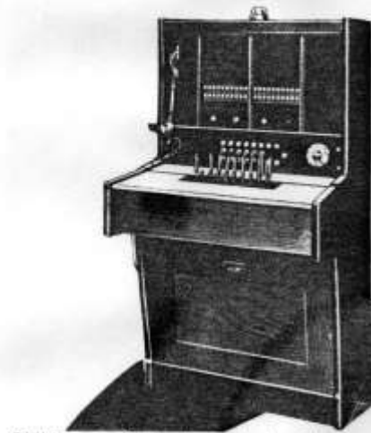
Glühlampen-Zentrale nach dem Ein- schnursystem
