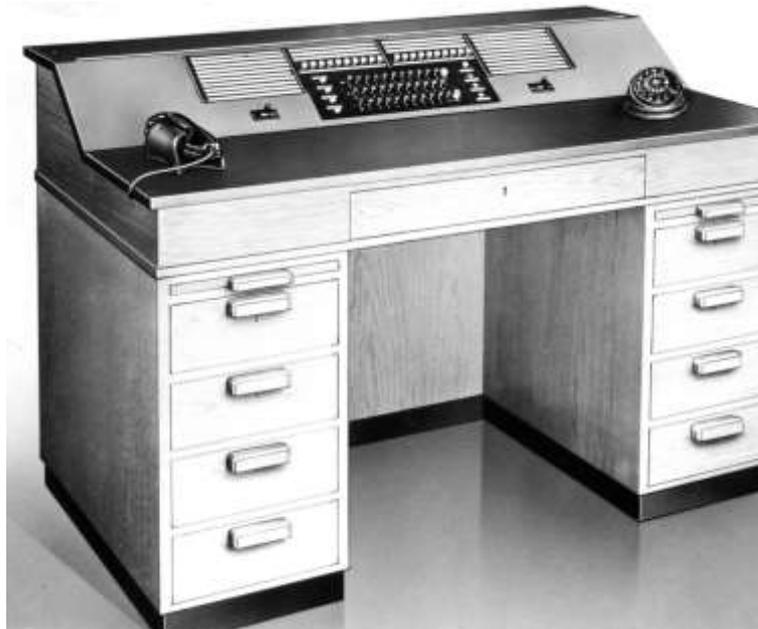
Jedem der beiden dargestellten Arbeitsplätze war, außer der Sprech- und Hörgarnitur mit dem Zahlengeber, bestehend aus 2x5 Tasten in der Anordnung wie bei Rechenmaschinen, eine Wählscheibe und verschiedene Überwachungsorgane zugeordnet.
