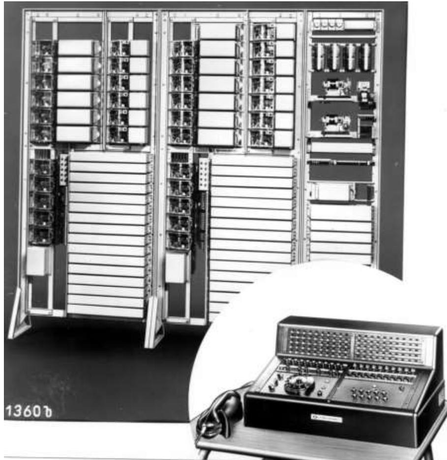
Neu an dieser Anlage war auch, dass bei Besetztzustand aller Verbindungssätze ein zusätzlicher Hilfssatz das Amtsbegehren eines Teilnehmers mittels Kennziffer trotzdem ermöglichte und in Folge einen freien Amtssatz zur Übernahme des Teilnehmers veranlasste. Sinngemäß galt das gleiche für den Anruf bei der Bedienung. In der ersten Ausführung dieser Viereckwähleranlage, nach dem Anruf Sucherprinzip, war der konstruktive Aufbau in Gestellbauweise konzipiert.
