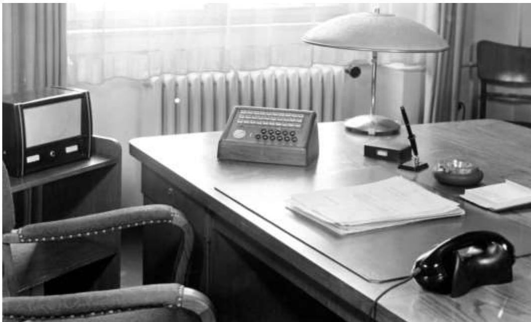
*Auf dem Beistelltisch die erste Ausführung einer TN-Freisprecheinrichtung.*
