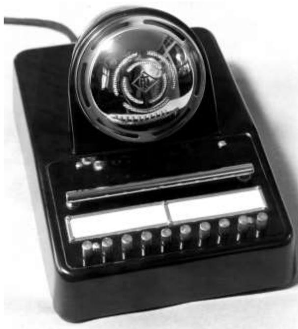
Mit Verstärker und Lautsprecher, die wie vorstehend unter der Beschreibung Tastenpult, gezeigt wurden hat dann die Telefonbau Normalzeit, Freisprecheinrichtungen zur Difag 10 und dem Wähler Schnellruf geliefert»
