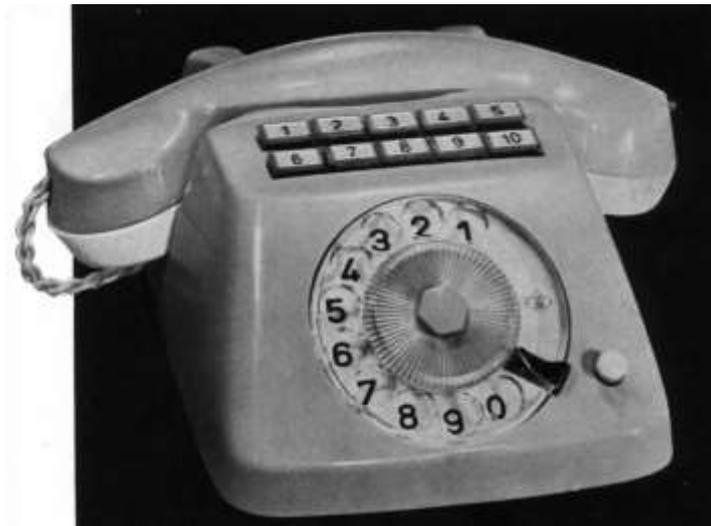
Anfangs wurde mit einer getrennten Konsole und einem Wählapparat eine Schnellrufeinheit bis 16 Schnellruf-Teilnehmer realisiert.
