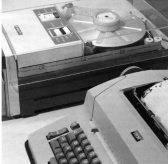
*Das Bild zeigt den genannten Locher und danebenstehend eine IBM Schreibmaschine mit ei. Eingabe. Auf dieser Maschine wurden z.B. fehlerhaft erkannte Datensätze und auch Privatgespräche, anstatt im Lochstreifen, im Klartext ausgedruckt.*
