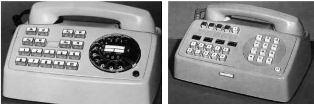
*Reihenapparat 4/10 Hauptstelle mit Zählern und IWV Tastatur*
