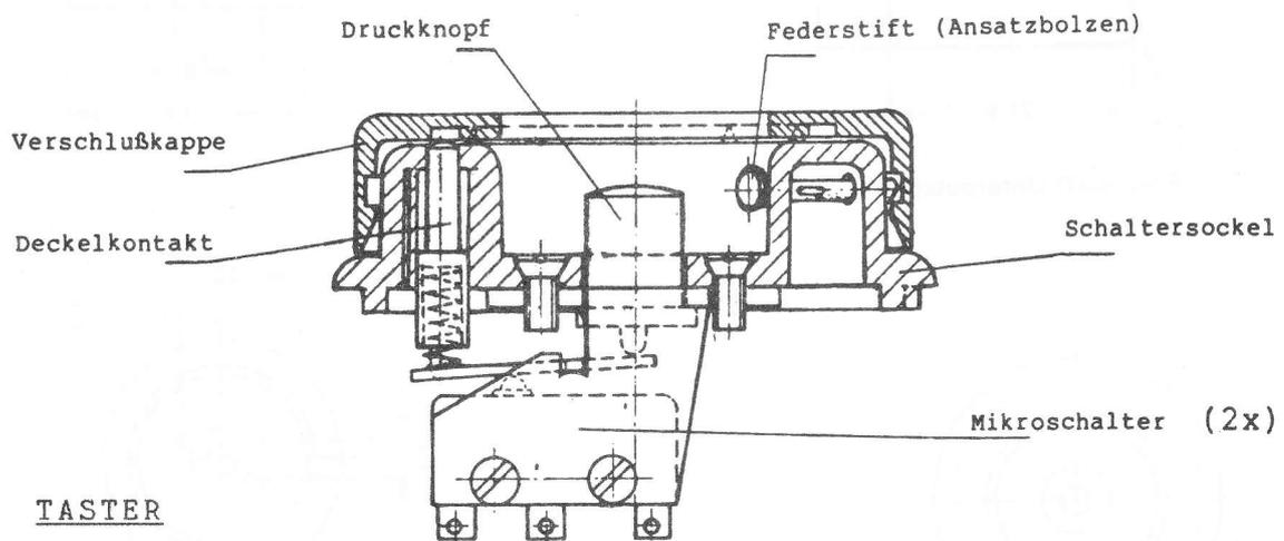
Die Verschlussklappe deckt die Schrauben zur Befestigung des Formstoffeinsatzes ab. (Überwachung durch Deckelkontakt).
