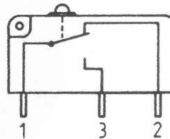
Bei Betätigen des Druckknopfes oder bei Auslösung des Deckelkontaktes sind die Anschlüsse 1 und 2 miteinander verbunden, im Ruhefall die Anschlüsse 1 und 3 (bei beiden Mikroschaltern gleichzeitig).
