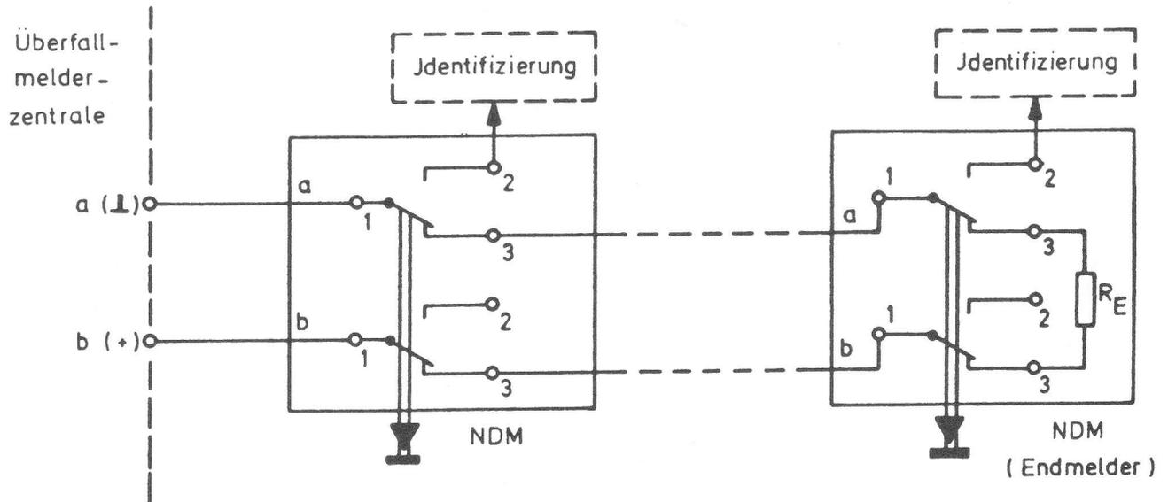
Der Endwiderstand  $R_E$  ist entsprechend der Gleichstromlinie der jeweiligen Zentrale zu wählen und wird im letzten Melder untergebracht.
