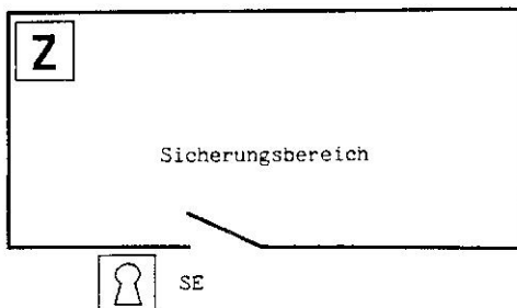
Abb. 3.27 Sicherungsbereich mit einer Schalteinrichtung
