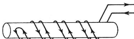
BILD 65 Prinzip der Bifilarwicklung
