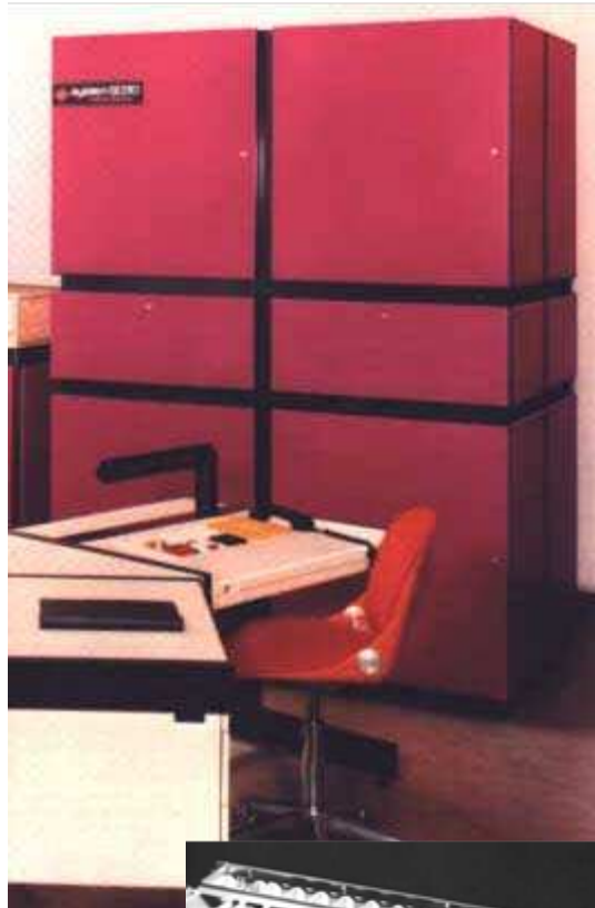
Modulator/Demodulator für Zeitmultiplex- Koppel- feld (PAM) in Dickschicht- technik
