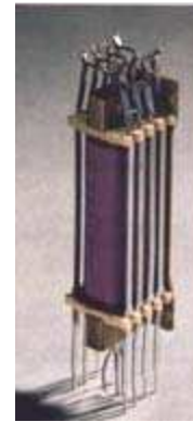
Multi-Reed-Relais (MRK) (in Glasrohr eingeschmolzener 4fach-Kontakt)
