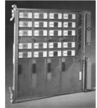
Baugruppe mit elektronischen Koppelpunkten
