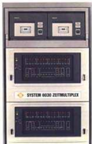
Modulator/Demodulator für Zeitmultiplex- Koppel- feld (PAM) in Dickschicht- technik
