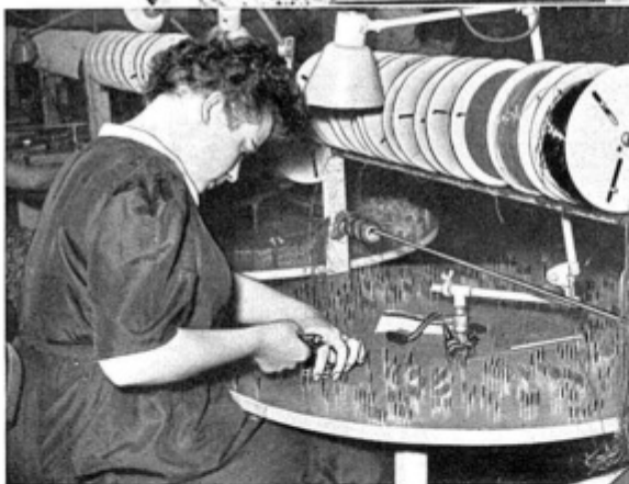
An diesen Drehtischen entstehen gleichzeitig jeweils 6 Kabelbäumchen für die Innenverkabelung der Telefonapparate
