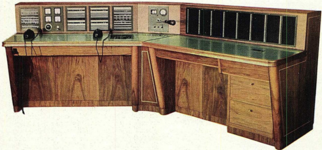
Zweiplätziges Feuermelde-Zentrale in getrennter Bauweise bei der Städtischen Feuerwehr Trier
