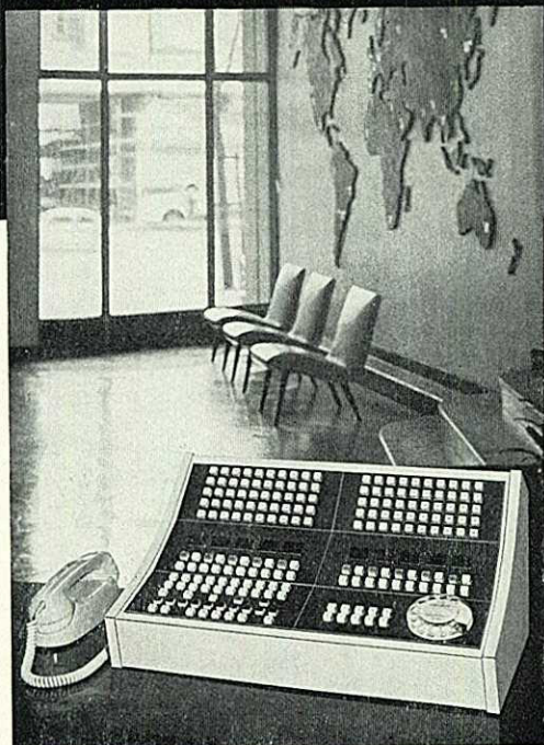
BILD 2 Leuchttasten-Universal-Zentrale der Baustufe II G mit steckbaren Baugruppen und neuem Vermittlungsapparat
