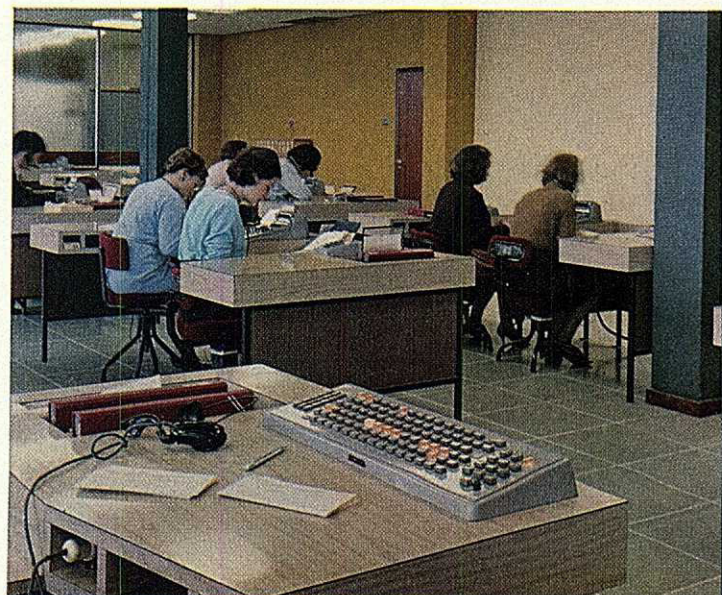
Fernsprechvermittlungs- und Buchungsplätze von Flugbuchungsanlagen, die Telefonbau und Normalzeit für die SABENA nach Brüssel und für die AIR LINGUS nach Dublin lieferte. Eine ähnliche Anlage wird demnächst für die AVIANCA in Bogotá eingerichtet.
