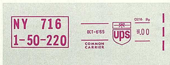
Zum Freimachen und Registrieren der Pakete werden alle wichtigen Daten einschließlich UPS-Gebühr mit einer Sonderausführung der POSTALIA-Frankiermaschine auf Klebstreifen gedruckt.
