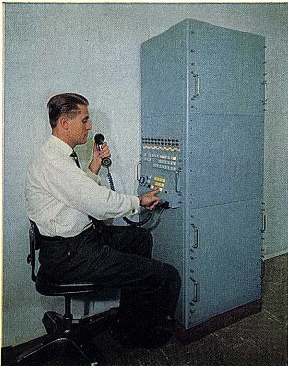
Eine elektronisch gesteuerte FRK-Fernsprechzentrale in Sonderausführung, entwickelt und gebaut von der Tele-Norm in New York.
