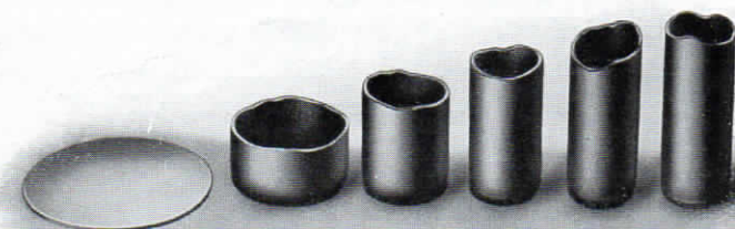
Abb. 6. Werdegang eines Relaismantels
