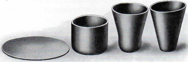
Abb. 4. Werdegang einer Schalmeischale
