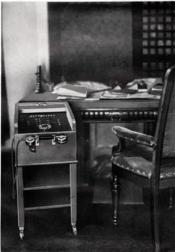
Abb. 7. Arbeitszimmer des Oberbürgermeisters, mit fahrbarem Fernsprechtisch „Pufu“
