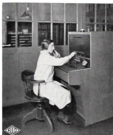
Abb. 20. Halbautomatische Fuld-Fernsprechzentrale für 6 Amtsleitungen und 20 Nebenstellen; dem internen Verkehr dient eine vollautomatische Zentrale für 23 Teilnehmeranschlüsse, in der Continental-Caoutchouc-Compagnie G.m.b.H., Dresden
