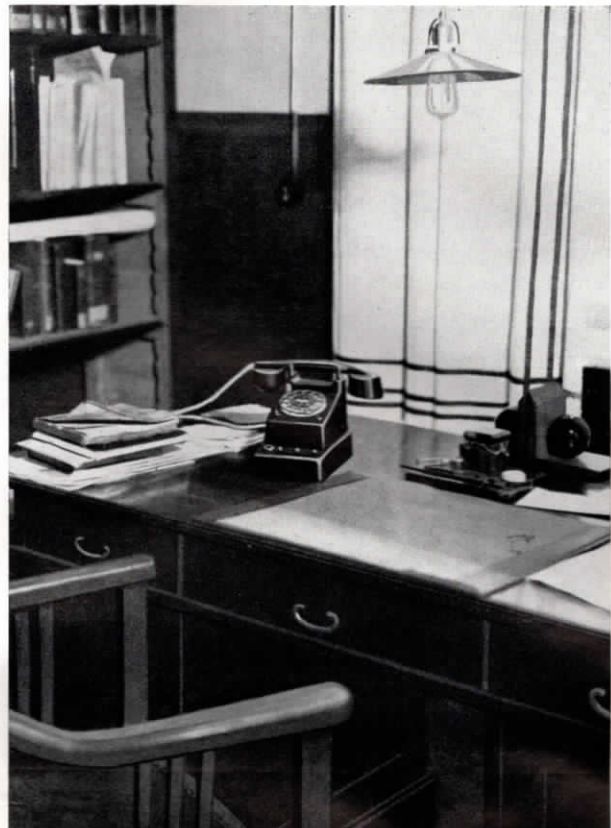
Abb. 10. Außenliegender Fuld-Nebenstellenapparat in der Volksbücherei
