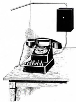
Abb. 19. Nebenstelle in Reihenschaltung (heutige Frankfurter Ausführungsform)
