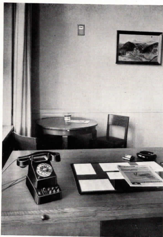
Abb. 3. Chefapparat und in die Wand eingebautes Städtetablo.
