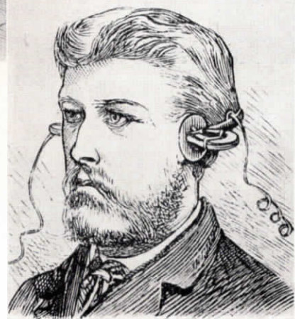
Abb. 135 Die Kopfbügel waren noch etwas primitiv und hatten Hörer mit freistehenden Magneten.
