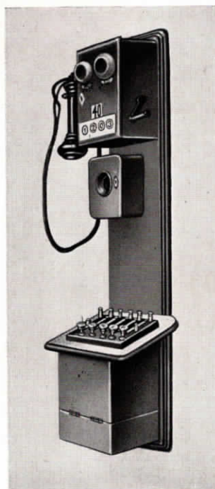
Abb. 137 Amerikanisches System Strowger, das noch nicht nach dem Prinzip der Drehscheibe arbeitete, 1893
