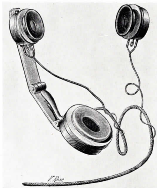
Abb. 148 Französisches Militär-Telefon, ist während des Transportes zusammenzuklappen. System Milde um 1892
