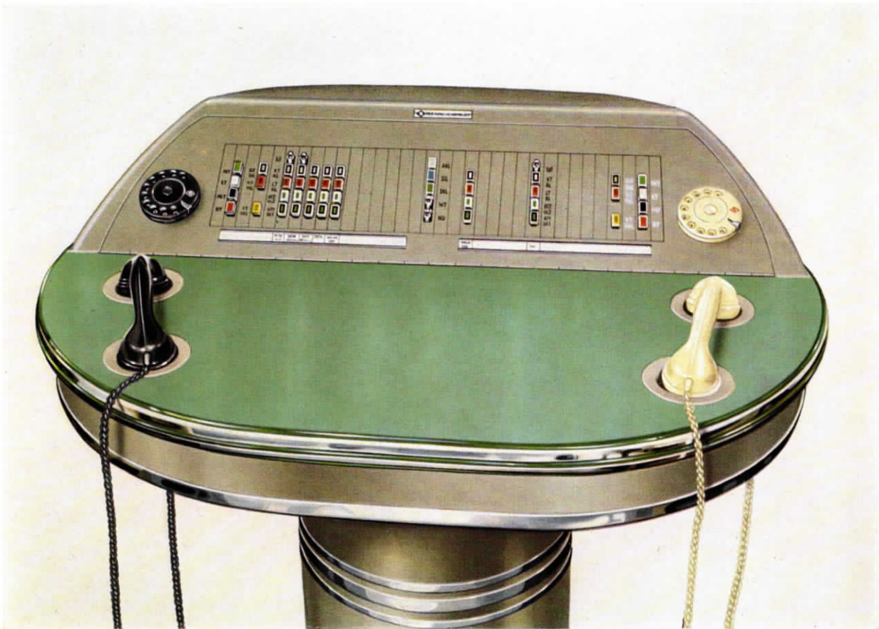
Neuzeitliche Ausführung einer Vermittlungseinrichtung mit Fernmeldeschaltplatte Die Vermittlung (Zuteilung) der Gespräche erfolgt mittels Leuchttasten
