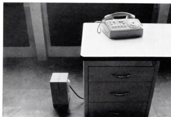
Der größere Teli-Tank zum Anschluß von Sonder-Apparaten
