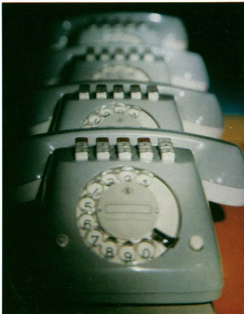
BILD 2 Die neuen TN-Reihenapparate in Multireed-Technik
