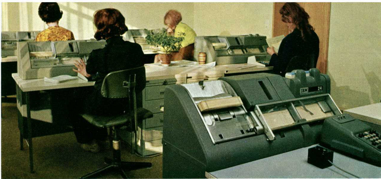
BILD 9 Im Vordergrund der von der Zentraleinheit des BDE-Systems Tenograph gesteuerte Ausgabeloher
