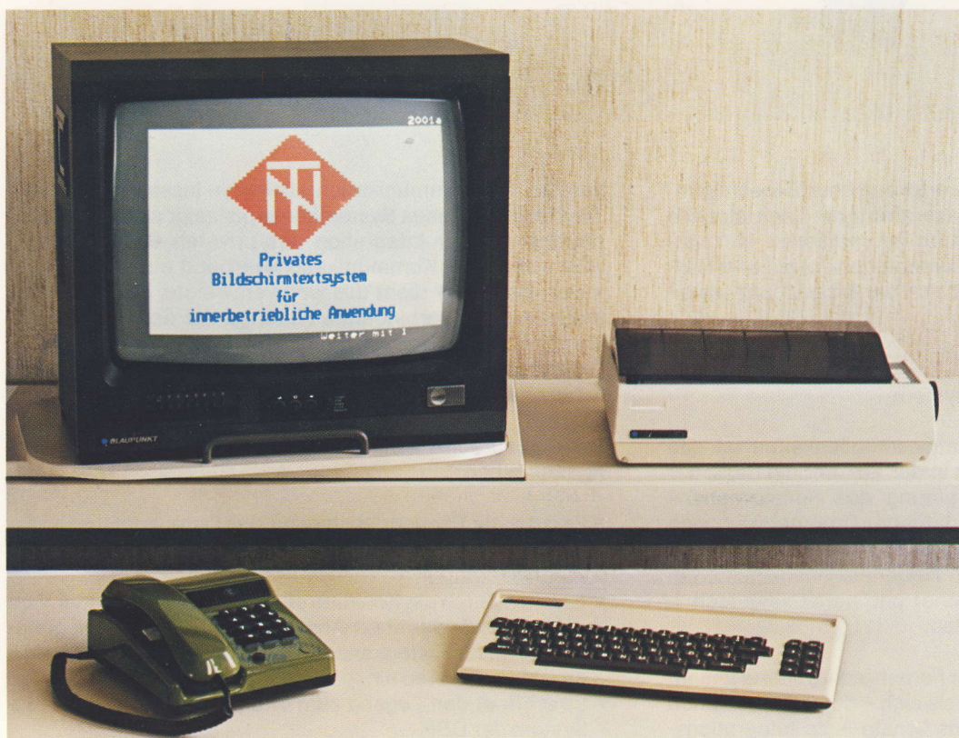
4 Bildschirmtext-Arbeitsplatz für Datenein- und -ausgabe und mit Editiermöglichkeit
