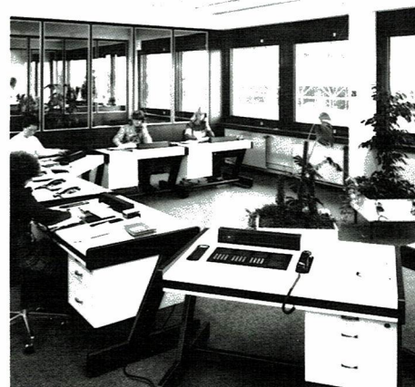
Das TN-Fernsprechsystem 6030 Zeitmultiplex in der Telefonzentrale eines großen Unternehmens in Düsseldorf
