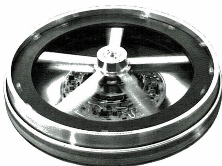
Das DRALLRAD sorgt für die Stabilisierung der Satelliten in der Umlaufbahn.
