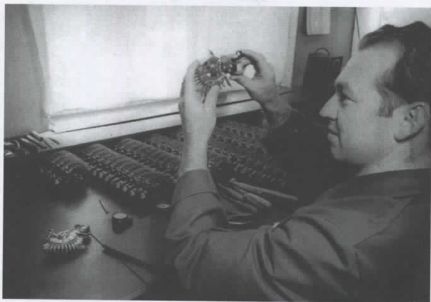
Überprüfung des Laufs des Drehwählers (Herbert Sulzmann)
