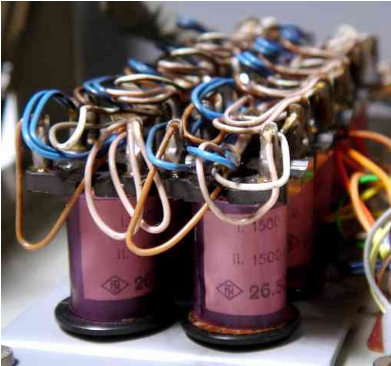
Induktive Drahtwiderstände je Teilnehmer 2x 1500 Ohm.
