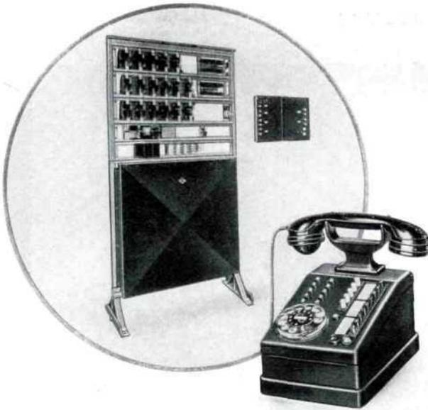
Bild 30 Universalzentrale mit Bedienungsapparat
