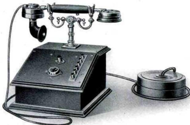
Bild 13 Reihenschaltungsapparat für 1 Amtsleitung, mit eingebautem Wechselschalter, Sperrsignal und Druckknopf-Linienwähler. Eigene Ausführung seit 1905
